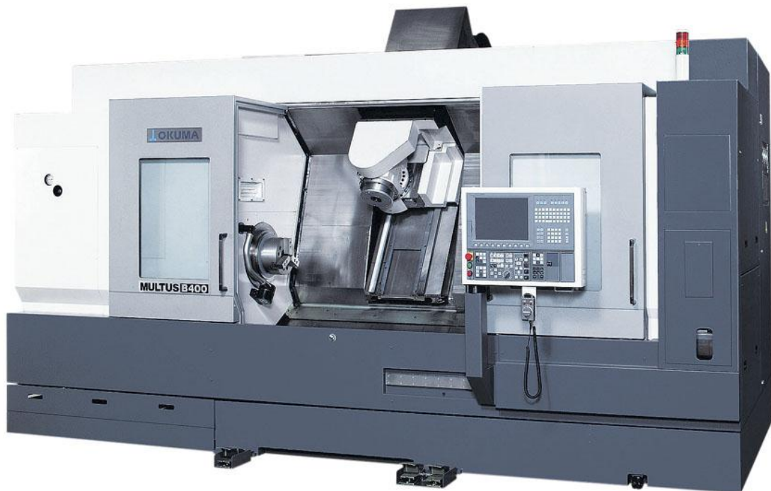
OKUMA MULTUSB400W multifunksjons dreiesenter med Y og B-akse samt Okuma OSP-P200L CNC styring med ISO og dialogprogrammering. IRCO stanglader.
